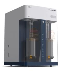
Используя данные такой изотермы оператор может посчитать дальнейшую информацию, такую как приближение изотермы Ленгмюра, кривые скорости адсорбции, кинетические кривые, TPD (температурно программируемая десорбция), PCT (давление-состав-температура) или PCI (давление-состав-изотерма) и т.п.,
