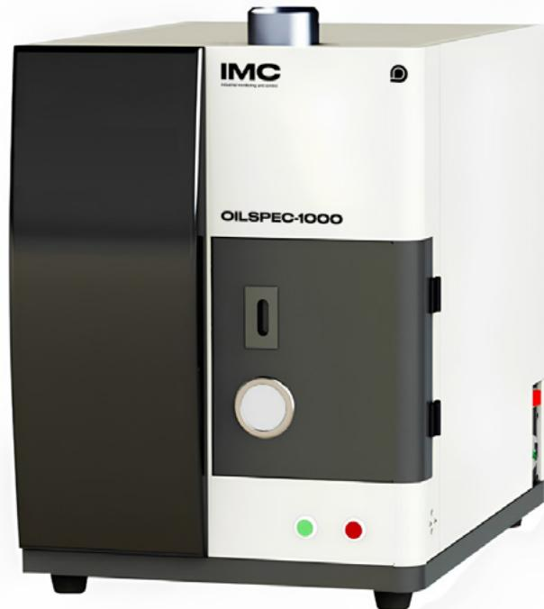
Прибор соответствует требованиям многочисленных стандартов в области контроля качества и состояния масел и топлив, в частности - ASTM D6595, ASTM D6728 и других. Спектрометр предназначен в первую очередь для использования в крупных автохозяйствах и на электростанциях, а также для обслуживания армейской техники. Его использование позволяет следить за износом механизмов для своевременного обслуживания и предупреждения аварий.
