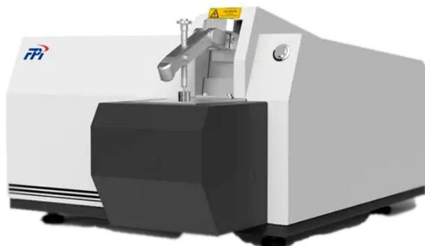
Опико-эмиссионная или атомно-эмиссионная спектрометрия с искровым возбуждением спектра – хорошо зарекомендовавший временем экспрессный метод анализа, основанный на одновременной регистрации излучения атомных спектральных линий элементов, возникающего в высоковольтном искровом электрическом разряде между стержневым электродом и предварительно подготовленной поверхности проводящего образца.
